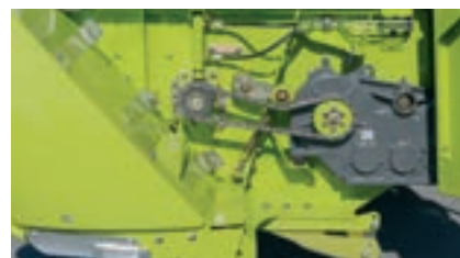
DIRECT DISC 610/520: опционально с гидравлической регулировкой лопастного вальца
