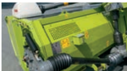
Мощная трансмиссия с трехступенчатым редуктором
