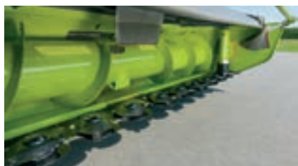
DIRECT DISC 600/500 с подающим шнеком большого размера
