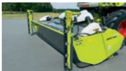
DIRECT DISC 600/500: опционально прорезные ножи, со встроенным гидравлическим приводом
